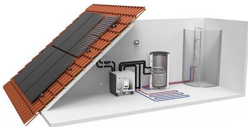
Figuur 7.6 | PVT-paneel gekoppeld aan warmtepomp. Bron: Qsilence
